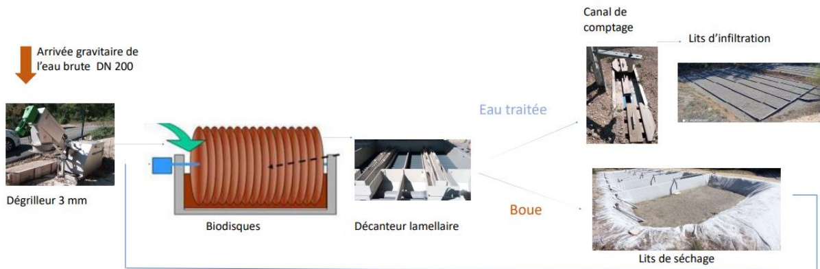
Figure 51 : Synoptique de traitement de la nouvelle STEP du pigeonier basée sur des bioprocédés avancés pour traiter les effluents du Hameau du pigeonier avec une capacité de 350 EH.
